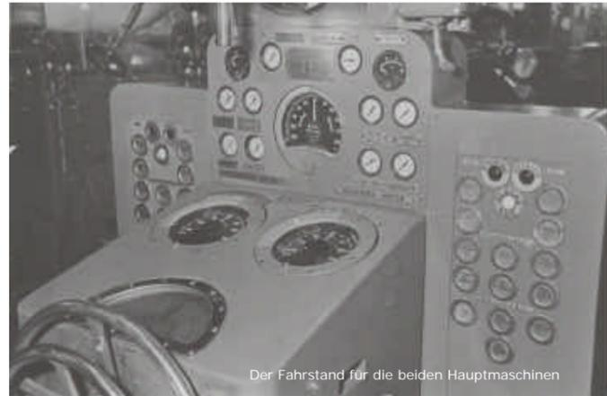
Der Fahrstand für die beiden Hauptmaschinen
